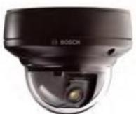
Ультра-компактная поворотная камера AutoDome – Full HD 1920 1080px – x10 оптический зум, обзор 360° – 24 В переменного тока или источник питания POE (Power Over Ethernet) – HD-SDI выход – Черный цвет
