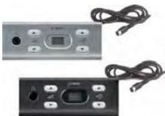
Панель селектора каналов – Две кнопки для регулировки уровня громкости наушников – Две кнопки для выбора одного из 32 доступных каналов – Функция памяти позволяет активировать последние использованные параметры (уровень канала и аудио) – Поставляется с кабелем 2м – Размер 40x100x82 мм – Потребляемая мощность 0,9 Вт
