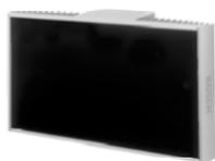
Цифровой инфракрасный излучатель 12,5Вт – Совместимость с 32 каналами – Выбор переключения передачи мощности (100% или 50%) – Светодиоды (активный, в режиме ожидания, неисправность) – 2 BNC разъема (вход / выход, 75Ω коаксиального кабеля) – Два переключателя компенсации задержки для компенсации различий в длине кабелей между передатчиком и излучателями – Регулировка угла наклона излучателя – Для настенного монтажа, на потолке или штативе
