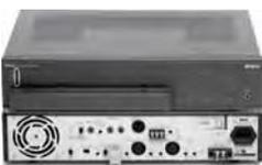
Контурный усилитель для людей с нарушением слуха NF EN60849 – Покрытие + / 600 м<sup>2</sup> – Максимальная ширина индуктивной петли 12м – Возможность синхронизации нескольких PLN-1LA10 – 2 микрофонных / линейных входа – 1 приоритетный вход 100V – Поставляется с монтажными кронштейнами для 19" стойки – 2U
