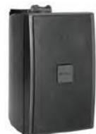
2-полосный громкоговоритель 30Вт/100В или 8Ом. ABS пластик. Для использования в помещениях. Поставляется с монтажным кронштейном для горизонтальной или вертикальной установки. Мощность переключателя 1, 1/2, 1/4, 1/8. Поставляется с кабелем 2м. Доступен в 2 цветах: белый RAL9010 LB2-UC30-L - антрацит RAL7021 LB2-UC30-D
