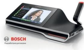
Конференц-пульт со встроенным сенсорным экраном для проведения конференции, просмотра презентационных материалов, видео и выхода в Интернет – Максимальная разборчивость речи благодаря инновационным акустическим технологиям – Четкий 7" сенсорный экран – Интуитивно-понятное сенсорное управление ОС Android
