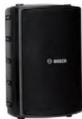
2-полосный громкоговоритель 350 Вт. EN54-24. 70V, 100V. ABS-пластик. Использование в / вне помещений. Керамический терминальный блок для кабеля CR1-C1. Место для установки карты Praesideo мониторинга. Разъемы ввода / вывода. Черный цвет. Дополнительный монтажный кронштейн. 34кг. IP65
