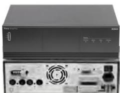
Усилитель 480Вт – 2 входа с переключением по приоритету 0дБ XLR – 1 вход 100V – 2 выхода 0дБ для каскадирования усилителей – Светодиоды для отображения состояния усилителя – Выходы 70В, 100В и 8Ом – 230В или 24В – Поставляется с 2 XLR / XLR монтажными кронштейнами для 19"стойки – 3U
