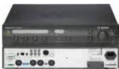
Микширующий усилитель 30Вт – 1 alarm-вход 0 дБ или 100В – 2 приоритетных микрофонных / линейных входа: 1 сухой контакт (евро разъем или XLR) и 1 VOX (XLR), 2 микрофонных / линейных входа (XLR), 3 линейных входа (RCA), 1 разъем RJ45 вход для проигрывателей PLE-WP3S2Z – 1 выход 0 дБ (XLR) - 1 выход 8Ом или 100В – 230В или 24В (зарядное устройство 1А) – Поставляется с монтажными кронштейнами в 19" стойку – 2U
