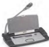
Concentus Пульт делегата с электронным голосованием, селектором 32 каналов, LCD дисплеем с подсветкой и кард-ридером – 5 кнопок для голосования – Два разъема 3,5 мм с независимым регулятором уровня громкости для наушников или нашейной индукционной петлей для слабослышащих (HDP-ILN) – Вход для внешнего микрофона разъем 3,5 мм – 1 разъем RJ45 для подключения дополнительной телефонной трубки домофона (LBB3555/00) – 1 цифровой вход управления – Длина кабеля 2м – Потребляемая мощность 4,2 Вт
