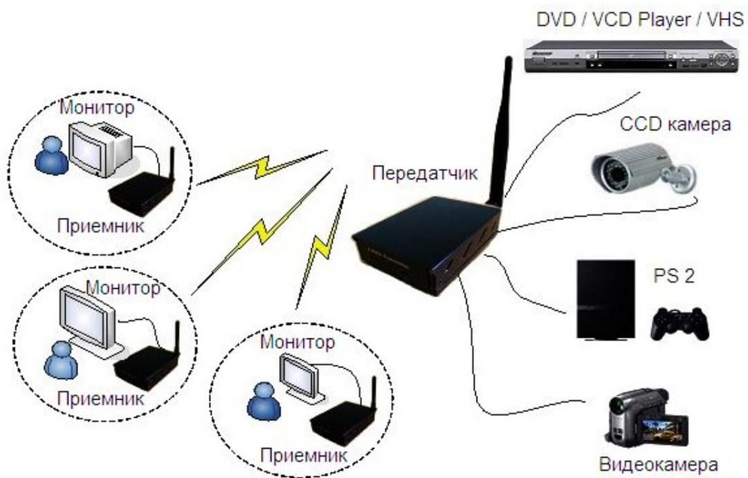
Рис.5 Схема подключения (один передатчик – несколько приемников)
