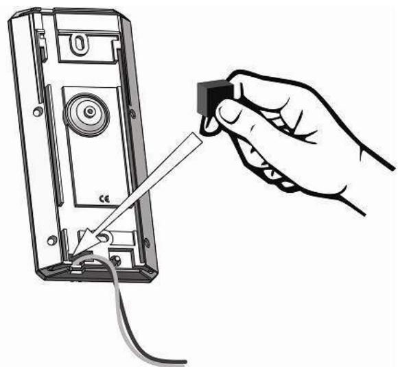
11. Установите детектор на кронштейн и зафиксируйте винтом.
