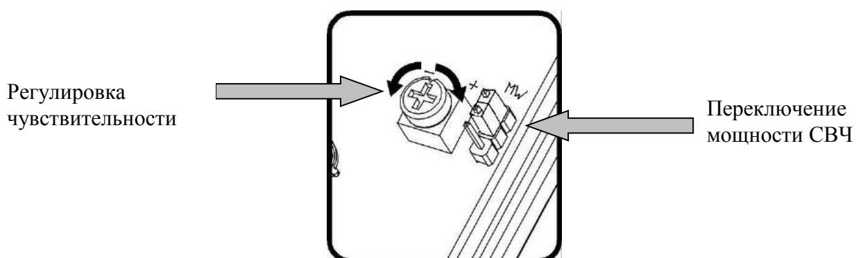
Регулировки чувствительности осуществляются потенциометром и СВЧ джамепром рядом с ним ( положение стрелки потенциометра ориентировано на часовой циферблат )
