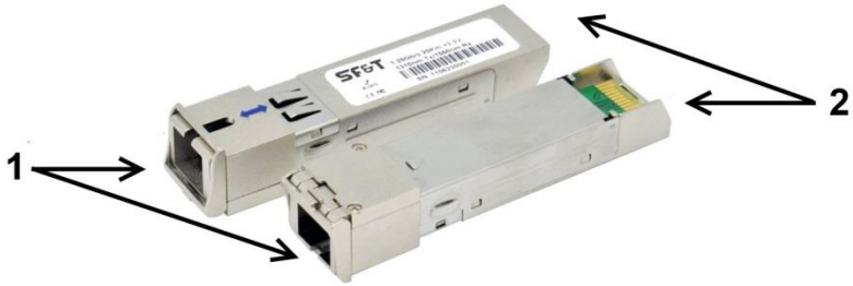
Рис. 1 Расположение элементов SFP-модулей
