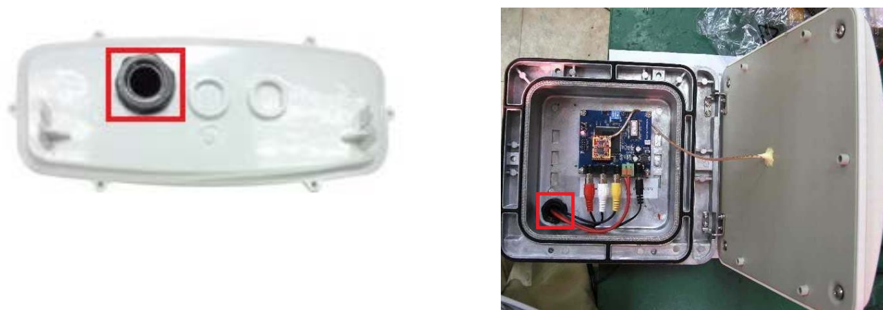
Рис.9 Подключение оконечных устройств (кабель для передачи композитного видео и аудио, антенны, питания, RS-485) через гермоввод.
