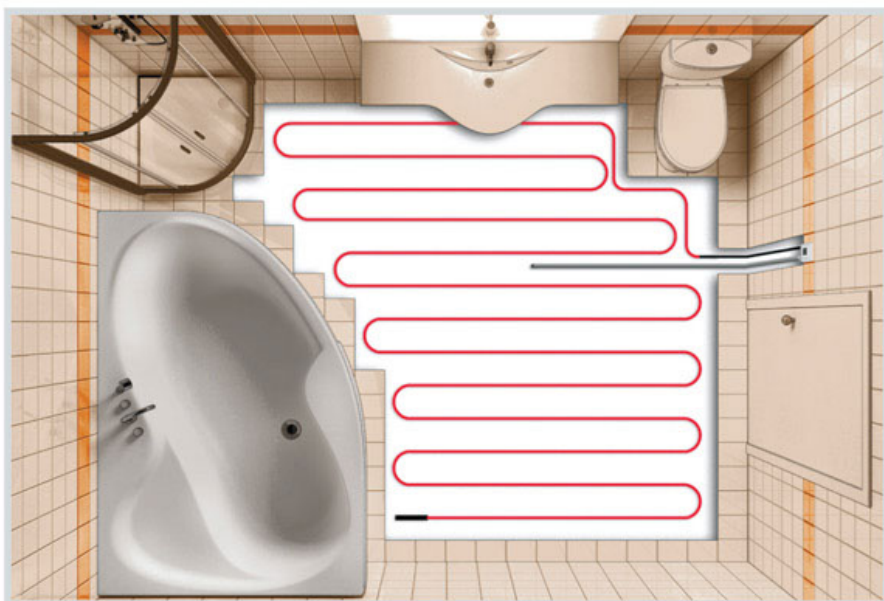
Схема укладки кабеля на свободную площадь
