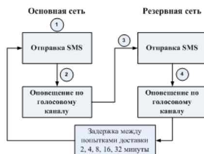
Рис. 4.3. Алгоритм оповещения в режиме автономной охраны
