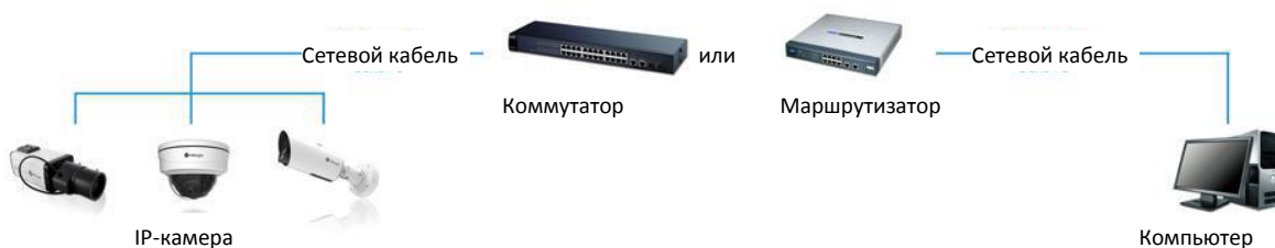
Рисунок 2-1-2 Подключение через коммутатор или маршрутизатор
