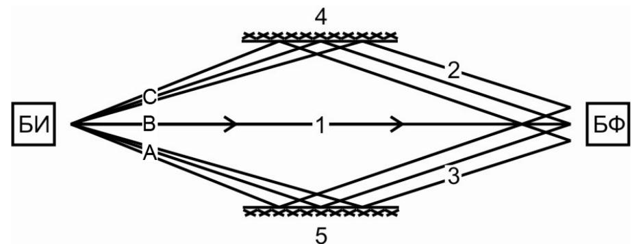
При этом, в зависимости от отражательной способности ограждающих поверхностей (или предметов) 4 и 5, энергии переотраженных ИК лучей может оказаться достаточно для сохранения дежурного режима при перекрытии прямого ИК луча 1.
