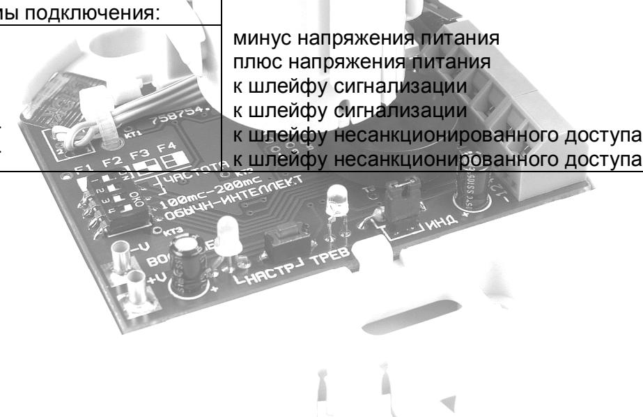
1.4.8 При включении режима «Настройка» (кнопка НАСТР в БФ) включается световой индикатор НАСТР, который индицирует уровень ИК сигнала на оптическом окне БФ, что значительно упрощает юстировку блоков извещателя и позволяет провести ее без применения внешнего вольтметра.
