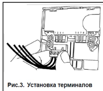
Рис.3. Установка терминалов
