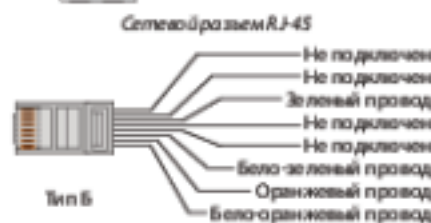
Расцветка коммутационных проводов вызывной панели ML-20IP
