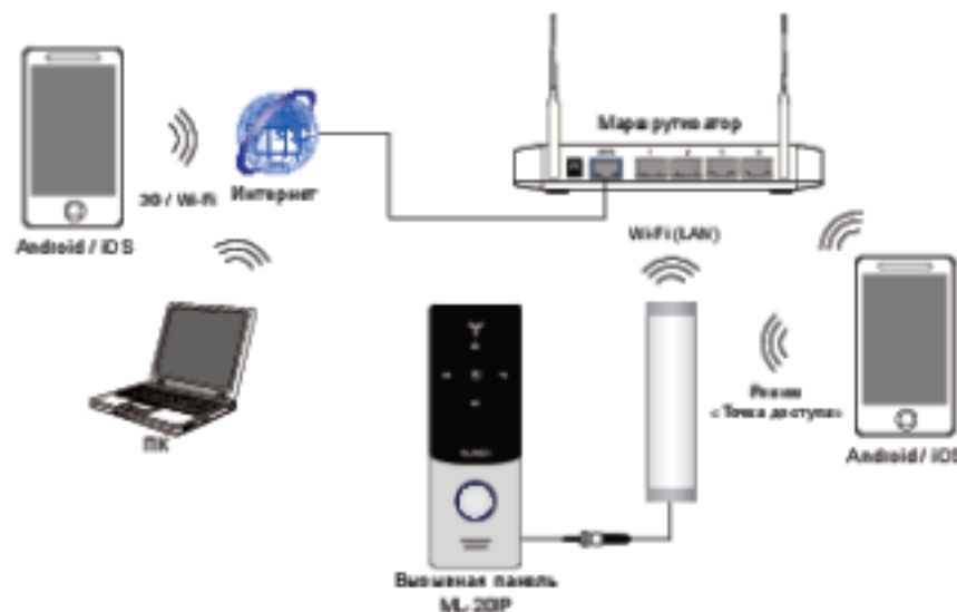
Схема 3. Подключение панели ML-201P к сетевому интерфейсу посредством беспроводного Wi-Fi соединения.
