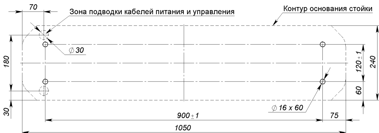
Рисунок 6 – Схема разметки для установки стойки КТ05.3
